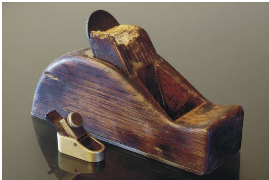
Abbildung 6: Deutscher (groß) und französischer (klein) Bogenmacherhobel aus der Werkstatt Gerbeth
